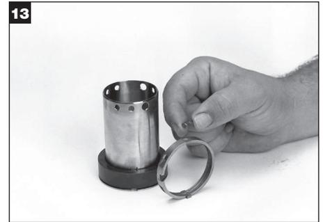
Se i due ganci di guida non sono già attaccati, installarli nelle scanalature del canale di flusso. Nota: Ci sono quattro ganci di guida per le dimensioni superiori a 60 mm (2.50 poll).
