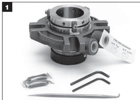
Per smontare la tenuta sono necessarie le chiavi esagonali fornite con la tenuta, un estrattore per O-ring o un fermaglio per carta.
