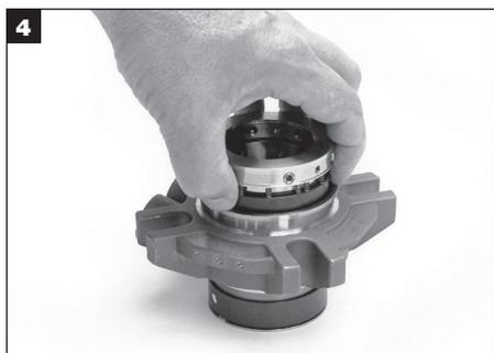
Togliere con attenzione l'anello di bloccaggio ed il gruppo della rotante tenendo l'anello della rotante della tenuta così come anche l'anello di bloccaggio. Questo evita che cada l'anello della rotante della tenuta. Mettere il gruppo dell'anello di bloccaggio con l'anello della rotante della tenuta verso l'alto.
