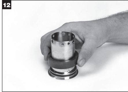
Lubrificare l'O-ring interno della bussola con il grasso al silicone fornito con la tenuta ed installarlo nella sua sede. Lubrificare l'O-ring della rotante della bussola ed installarlo nella sua sede all'esterno della bussola. Far scorrere fino in fondo l'anello di bloccaggio della rotante sulla bussola, allineando le guide della bussola con le scanalature dell'anello della rotante della tenuta.
