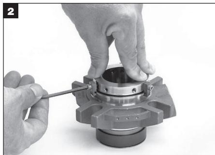
Mettere la tenuta su un piano con l'anello di bloccaggio rivolto in alto. Rimuovere i ganci di centraggio.
