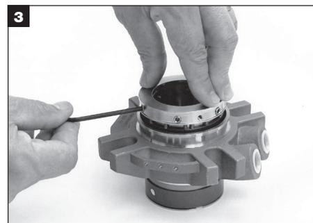
Premendo sull'anello di bloccaggio, svitare tutte le viti disimpegnandole dalla bussola.
