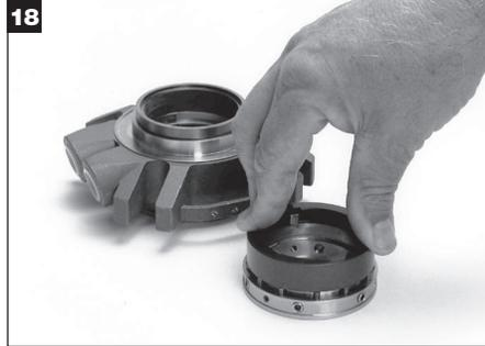
Far scorrere l'anello della rotante della tenuta esterna sopra all'anello di bloccaggio fino a che è sopra all'O-ring, allineando le guide con le scanalature della faccia rotante. Premere sull'anello della rotante della tenuta comprimendo le molle per accertarsi che l'anello della rotante della tenuta si possa muovere liberamente. Pulire le facce dell'anello della rotante e della stazionaria con uno straccio pulito e senza filacce.
