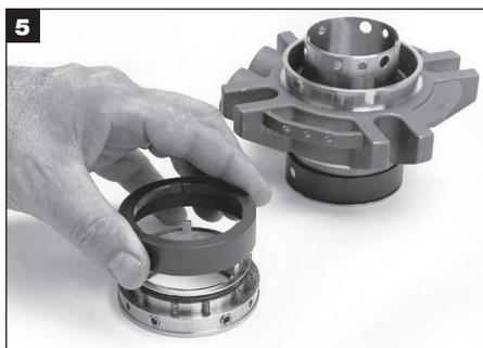
Separare l'anello della rotante della tenuta e l'anello di bloccaggio.
